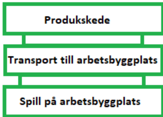
Figur 17: Livscykel delad under flera moduler vid nytillverkat bärande element av KL-trä enligt EN 15978.
