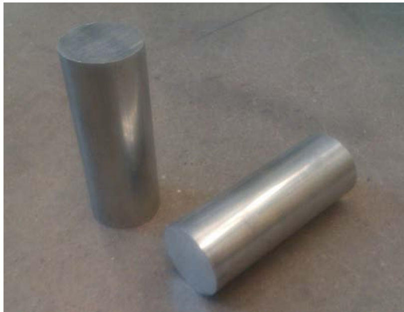
Figur 1. Cylindriska kutsar av aluminium.
