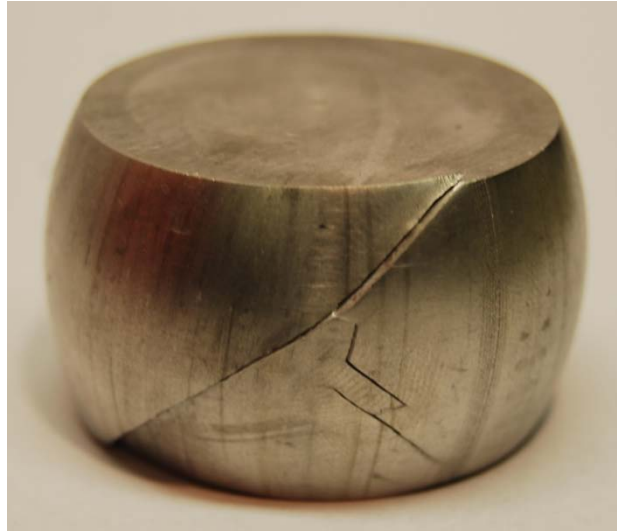
Figur 5. Stukad kuts utan smörjning.
