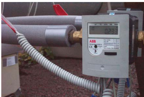
Figur 3, till vänster: värmemätaren SVM F2 på den östra delen av de studerade kretsarna till höger: instrålningsmätarna, överst för diffus och under för global instrålning
