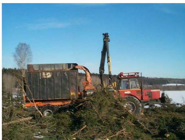
Figur 1. Toppar och klenare träd (under timmerdimension) flisas direkt på hygget, varefter flisen transporterades till avlägg och tippas i container.
