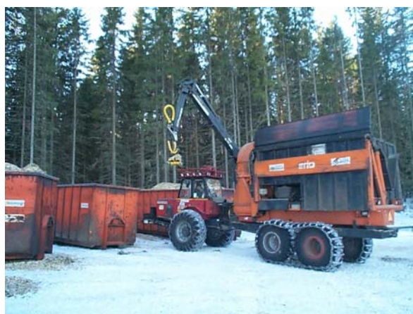
Figur 1. Toppar och klenare träd (under timmerdimension) flisas direkt på hygget, varefter flisen transporterades till avlägg och tippas i container.
