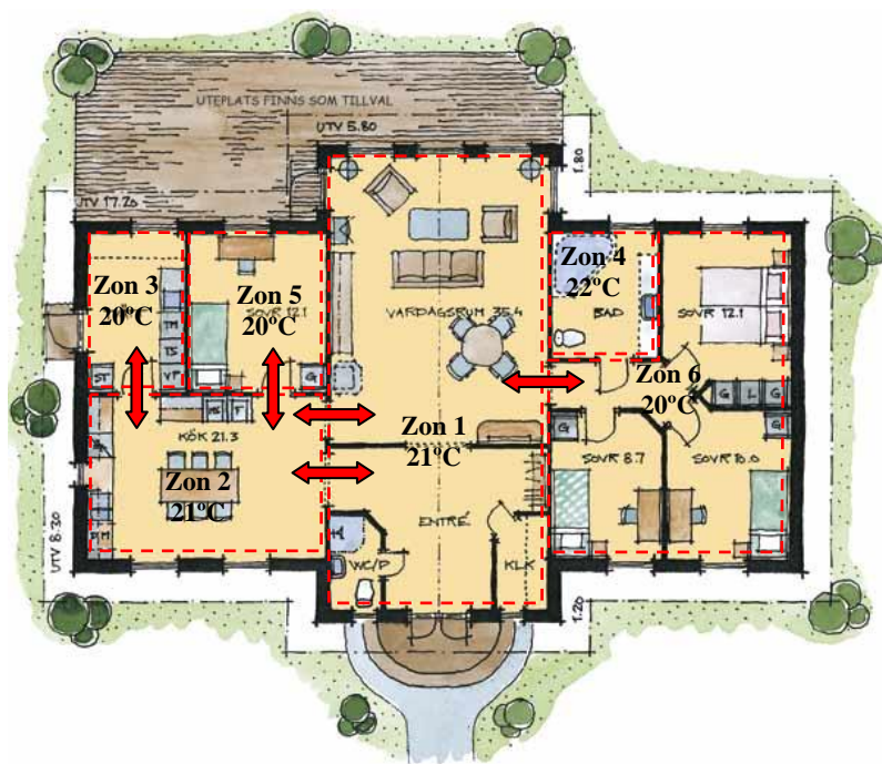
Figur 2.1. Det simulerade enplanshuset från Fiskarhedenvillan [21] på 143 \text{ m}^2 och dess zonindelning som har modellerats i TRNSYS (skala 1:200). Pilar i dörröppningar visar simulerad värmespridning orsakad av egenkonvektion mellan de olika zonerna [21]. Dessutom förekommer luftflöden mellan zonerna orsakade av ventilationssystemet
