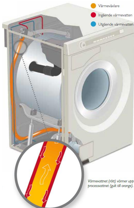
Figur 2.4. Tvättmaskinen med den nyutvecklade värmväxlaren. Bild från Asko Appliances AB [10].
