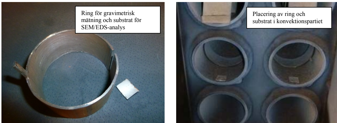
Figur 2.3. En av ringarna tillverkade av det rostfria stålet 1.4432 med sammansättning X2CrNiMo17-12-3. Ringarna placerades i tuberna och användes för den gravimetriska mätningen av beläggningar. Det lilla substratet med måtten 15 x 15 mm 2 är av samma material som ringarna polerades absolut rena och placerades bredvid ringarna i konvektionstuber.
